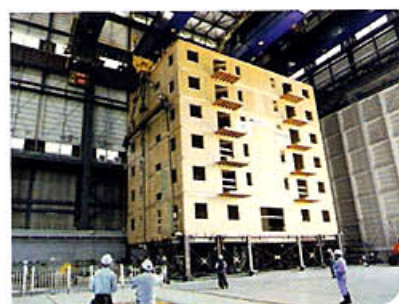
Ensayo en Japón, de un edificio de cinco pisos.
